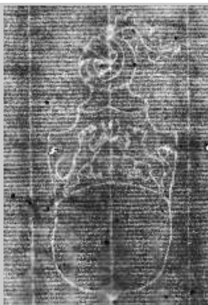
9 Wasserzeichen eines handgeschöpften Papiers (Kontaktabzüge von Beta-Radiographien). a (links): vor der Spaltbehandlung. Unschärfe Stellen sind bedingt durch die natürliche Wellung des Papiers. b (rechts): nach der Spaltbehandlung. Das Wasserzeichen ist noch lesbar. Die Einfügung des Kernpapiers erklärt den leichten Kontrastverlust.
