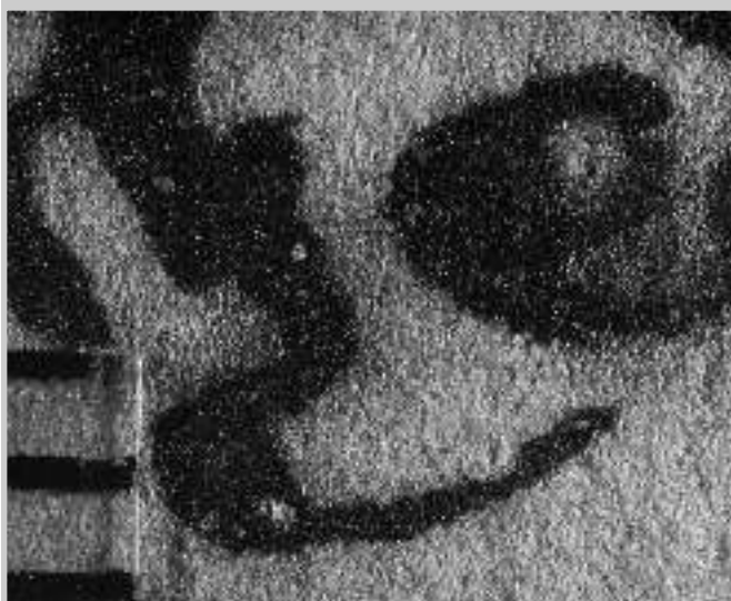
10 Eisengallustintenbeschriebenes Papier nach der Verstärkung durch Spaltung (Detail; eine Linealeinheit entspricht 1 mm). Eine Fehlstelle (0,5 mm Durchmesser) zeigt sich innerhalb der Tintenlinie.
