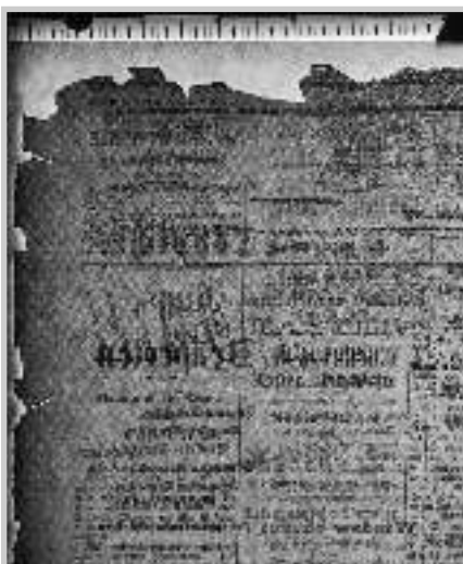
8 Zeitungsblatt nach der Verstärkung durch Spaltung (Detail, Durchlicht). Die ursprüngliche Wolkigkeit des Papiers ist gut erkennbar. Nur im oberen, rechten Bereich liegen die Spalthälften nicht vollkommen präzise übereinander.
