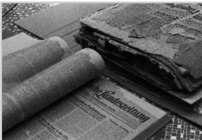
6 Durch Spaltung verstärkte Zeitungen an der Thüringischen Universitäts- und Landesbibliothek Jena. Unbehandelte Vergleichsobjekte liegen im Hintergrund.
