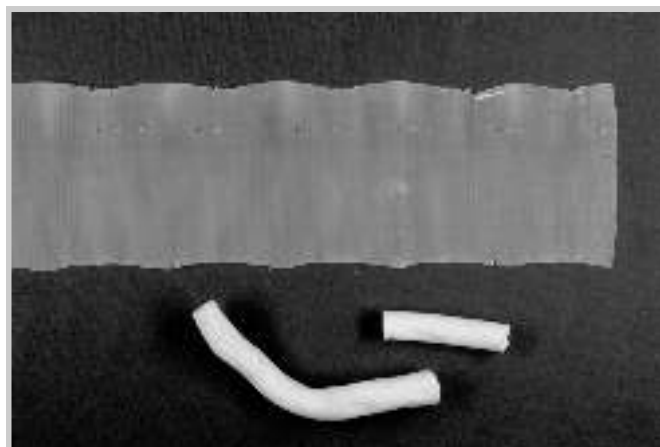
2 Markstange und Blatt: An der rhythmisch auftretenden Verletzung des Blattes befand sich eine Verwachsung im Ast.
