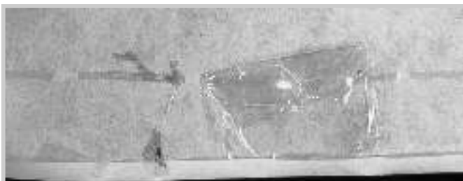
5 Zwei ausgewählte Gelatinefilme nach künstlicher Klimaalterung: Der Weichmacherzusatz hat die Glastemperatur der linken Probe soweit herabgesetzt, daß diese während der künstlichen Alterung überschritten wurde. Der Gelatinefilm ist vollkommen aufgeschmolzen.
