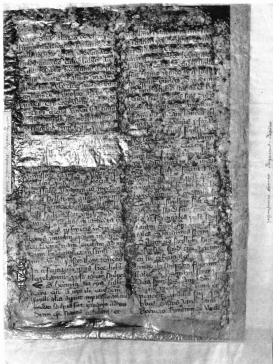
Abbildung 7: Beispiel für Pergamentrausbesserung mit glanz zepoliereten Japanpapier; das Pergament ist labig geworden, der Glanz der Streifen behindert die Lesefähigkeit (hier zur Verdeutlichung ohne Polarisationsfilter aufgenommen), die Streifen sind brüchig und vergilbt
