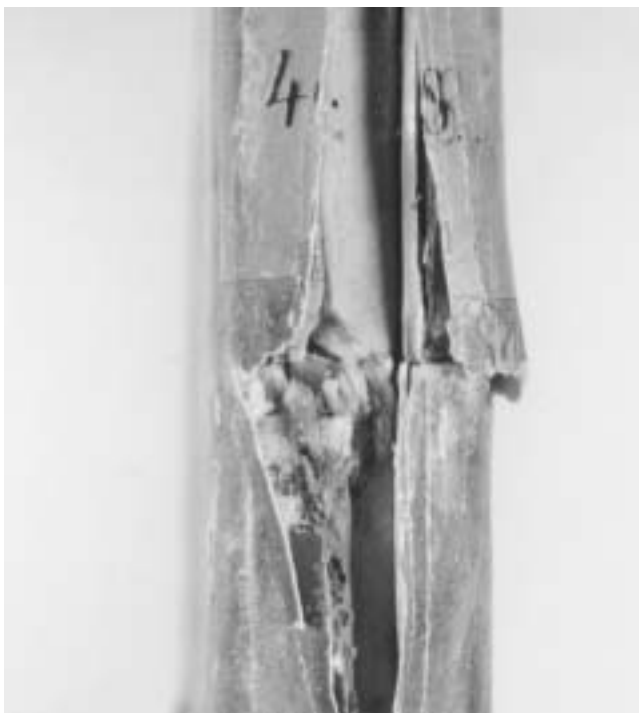
Abb. 3: StAZ GI 103, Vertikale Falten und Risse am Rücken
